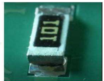
4. 납량이 적어 납땜이 안된 상태
