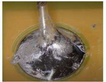
4. 과열이 된 상태 / 표면 산화된 상태
